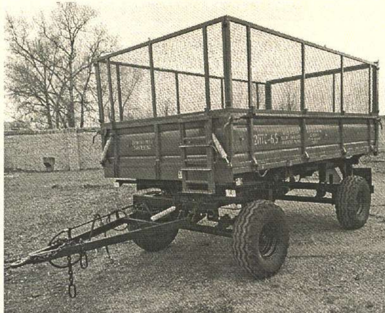
Фотография \frac{3}{4} заднего вида прицепа 2ПТС-6,5-01 (с надставными сетчатыми бортами)
